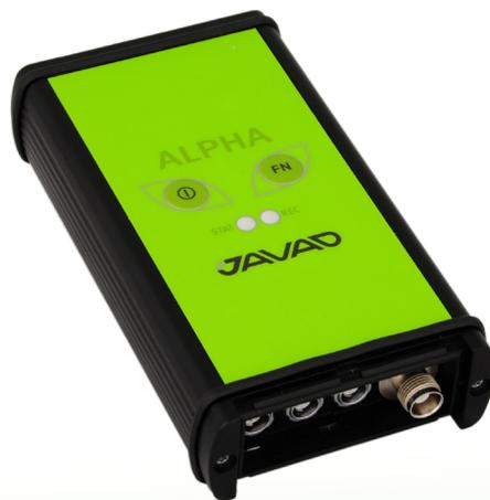
864 канала позволяют отслеживать все существующие и будущие спутниковые сигналы. Благодаря фильтрации напряжения, исключаются его пульсации, возникающие в случае подачи питания по кабелю. Батареи можно заряжать от любого источника питания с напряжением от +7 до +40 В. Приемник снабжен большим объемом памяти для записи и хранения данных. Кроме того, у ALPHA-3N есть интерфейс TriPad. П
